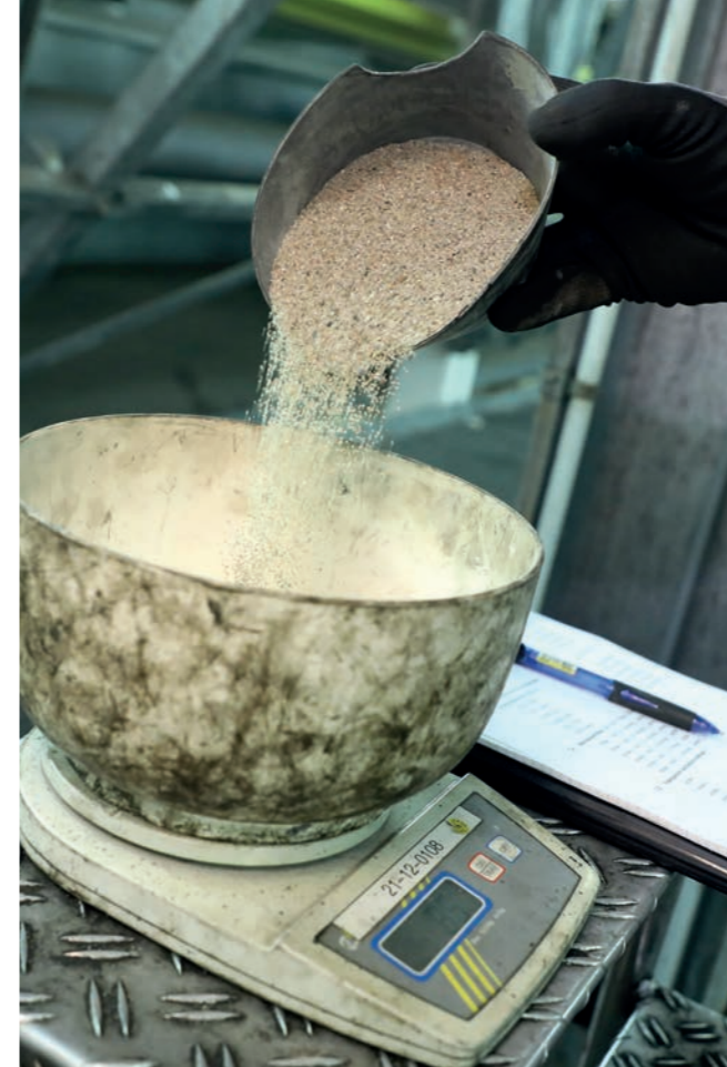
In den Stadtbahnen muss der Brems sand nachgefüllt werden.
